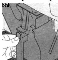
При установке рабочего блока на место не нажимайте рычаг "PRESS". Просто устанавливайте его в посадочное место с легким усилием.
